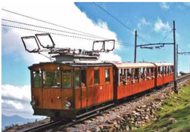
Le chemin de fer de la Rhune roule en triphasé (la troisième phase est au rail)
