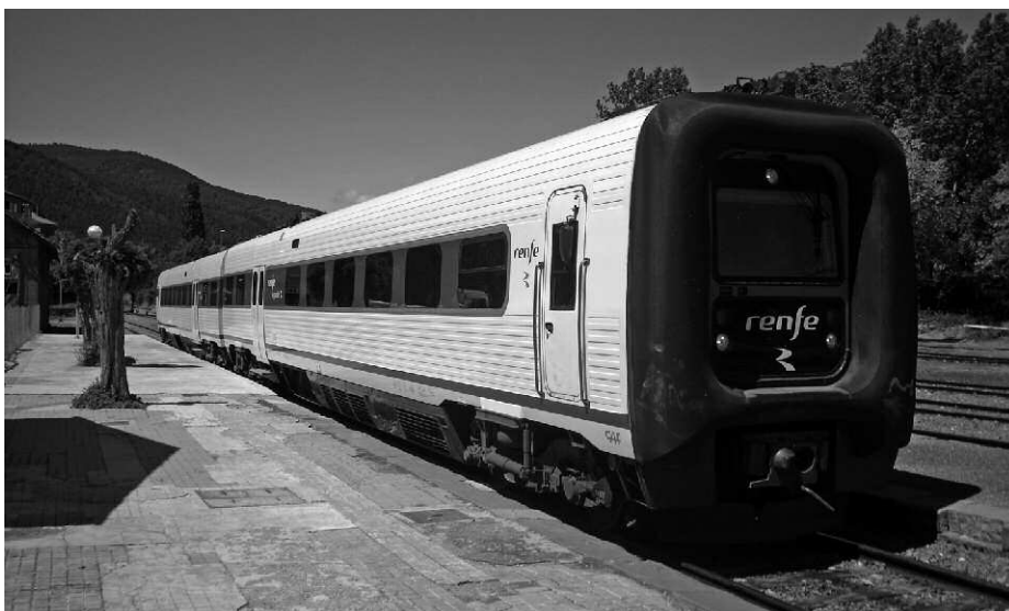
En gare de Jaca, l'autorail moderne de la Renfe de la série 594 (autorail CAF de 1700 cv apte à 160 km/h), engagé tous les jours sur la relation Zaragoza-Jaca. N'oublions jamais que les Espagnols continuent à desservir Canfranc par le rail, en voyageurs et en marchandises ! Bravo la RENFE ! – et ceci 41 ans après que l'État français ait déserté la ligne de Canfranc.
