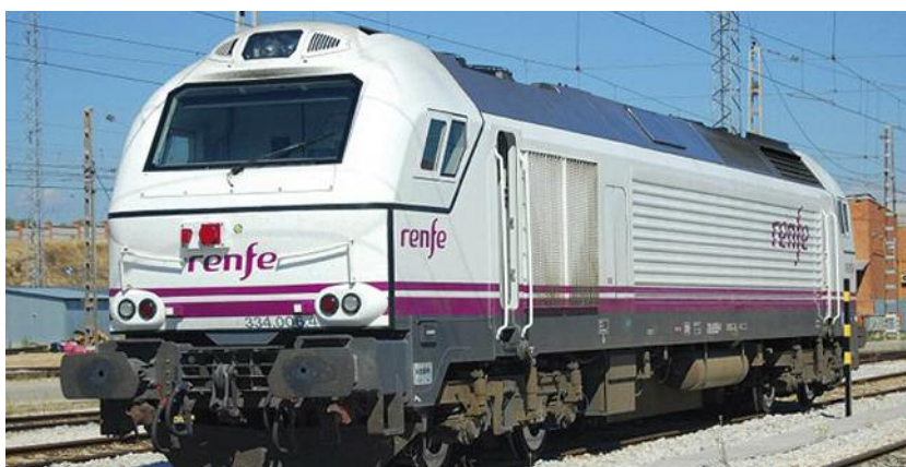
Diesel BB Vossloh Euro 3000 masse 82 tonnes, puissance 2460 kW, soit 3347 ch.
