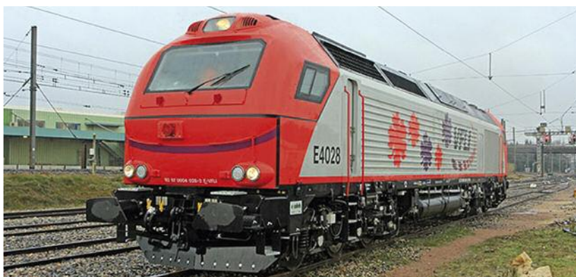
Diesel CC Vossloh Euro 4000 masse 123 tonnes, puissance 3178 kW, soit 4318 ch.
