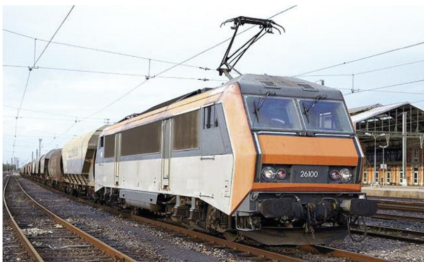
Electrique BB 26000 Alstom 90 tonnes puissance 5600 kW soit 7608 ch.
