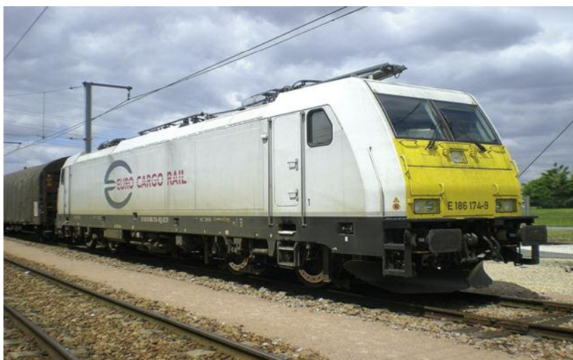
Electrique BB Traxx Bombardier Puissance 5600 kW 7608 ch poids 85 tonnes 4 essieux.
