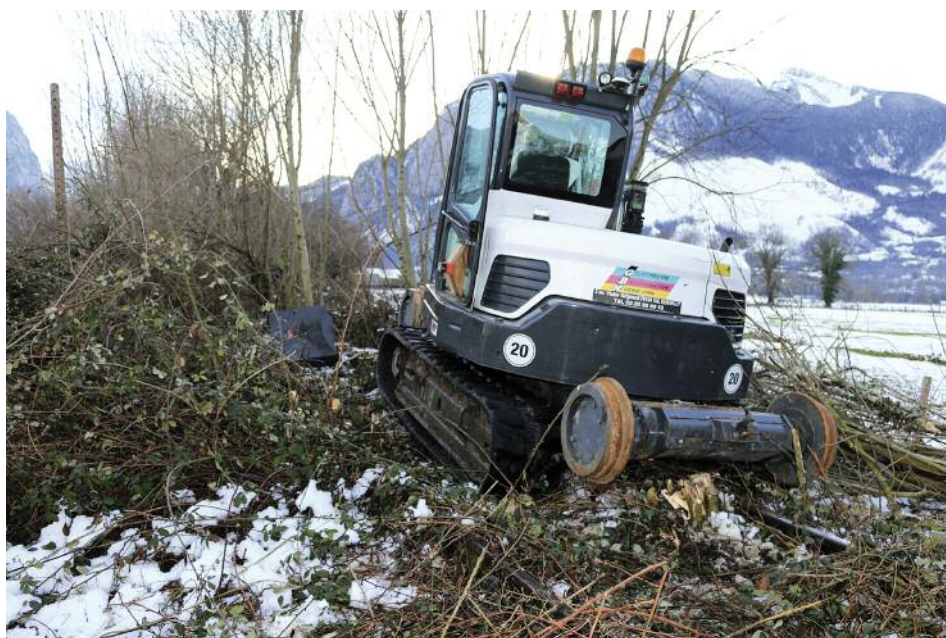
Janvier 2018, au-delà de Bedous. On remarque que l'engin dispose de roues à boudin relevables il est donc spécialisé dans les voies ferrées.
