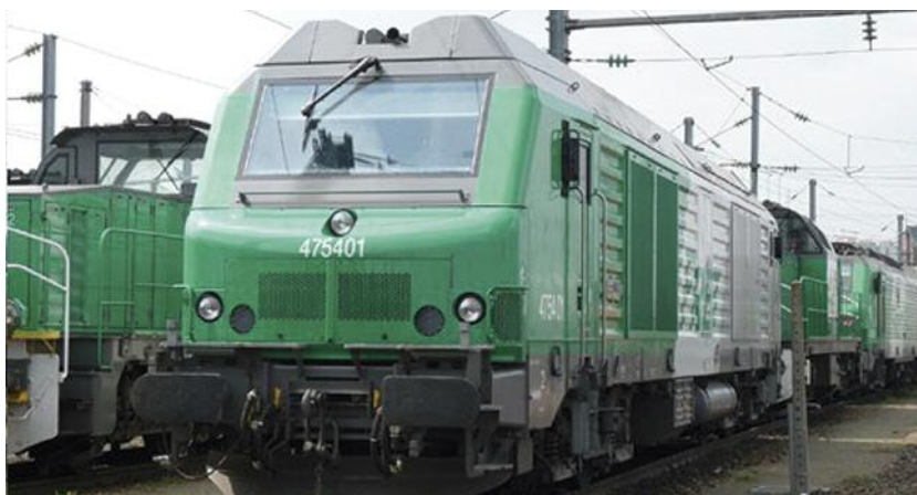
Diesel BB 75400 Alstom - Siemens masse 90 tonnes, puissance 2400 kW, soit 3260 ch.
