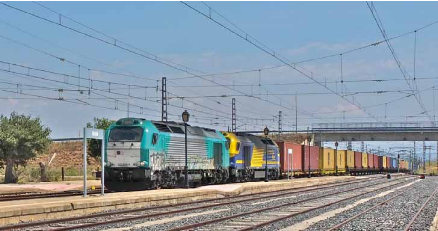
Deux Locomotives Euro 4000 Vossloh de 4300 cv chacune tractent un train provenant de la plateforme logistique de Monzon en direction de Saragosse. Ces mêmes locomotives pourraient être envisagées pour le Canfranc. (Photo Jean-Pierre Soustre).
